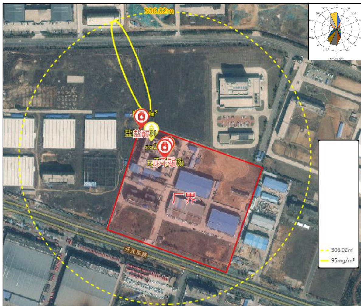
图 6.6-11 环丁砜泄漏燃烧次生 CO 扩散预测最大影响范围图
