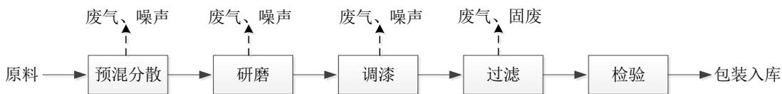
**图 2-1 营运期生产工艺流程及产污环节图**
