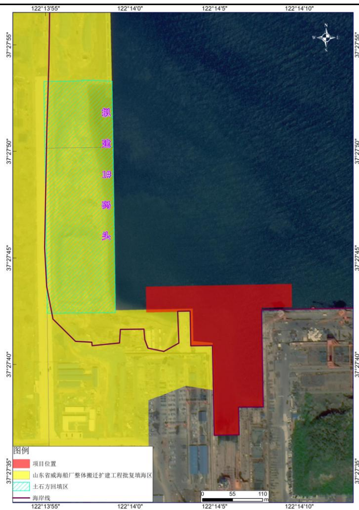
图 5-1 一期工程土石方回填区分布图
