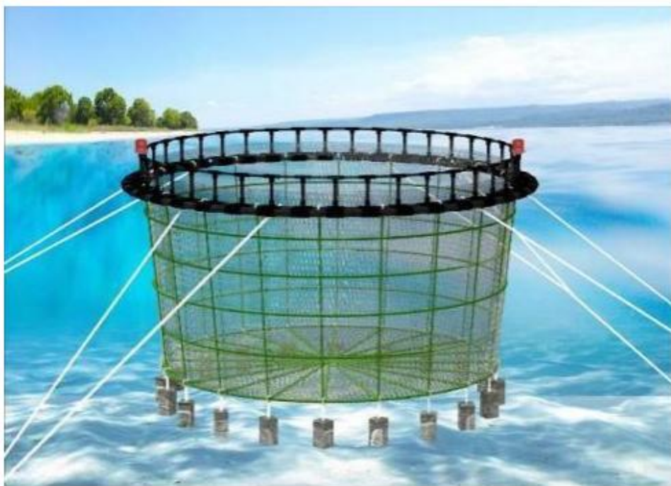
图 2-4 网箱框架结构示意图
