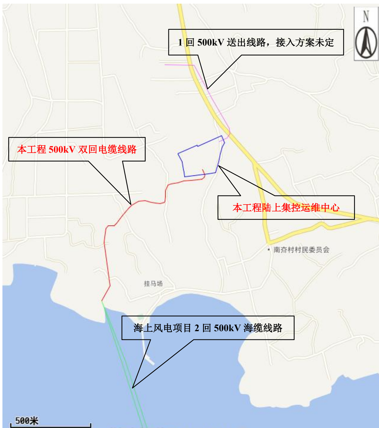
图 3.1-8 本工程投运后系统接线示意图
