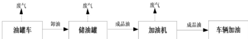
图 2-8 项目柴油运营工艺流程及产污环节图
