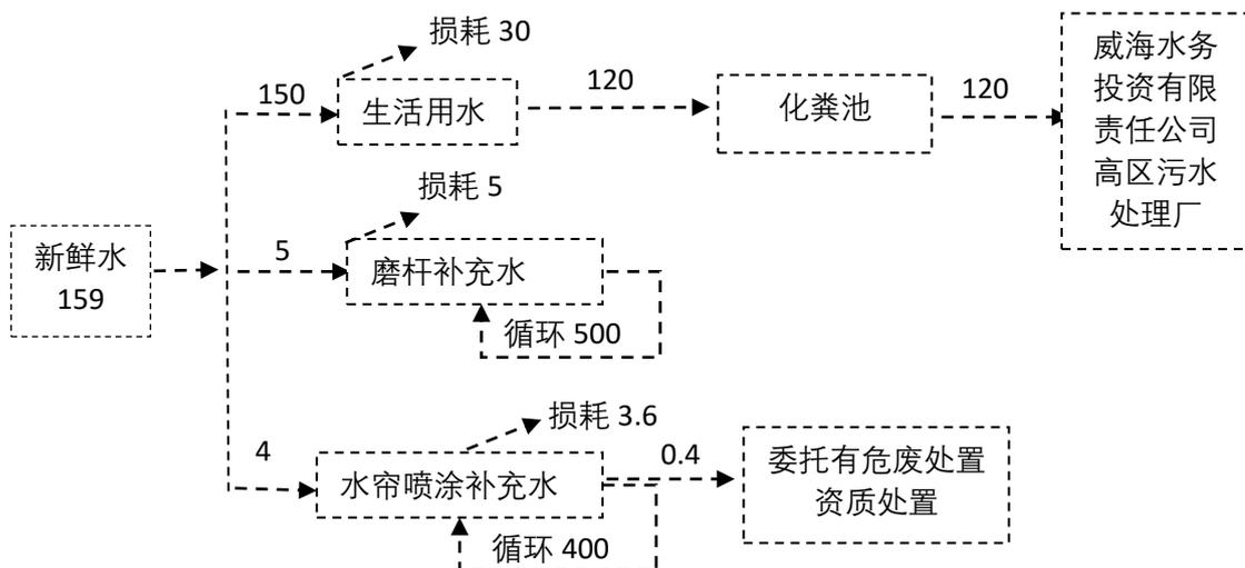
图 2-1 项目水量平衡图 (t/a)
