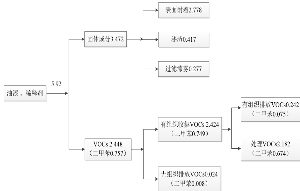
图 4-1 项目油漆、稀释剂物料平衡 (t/a)
