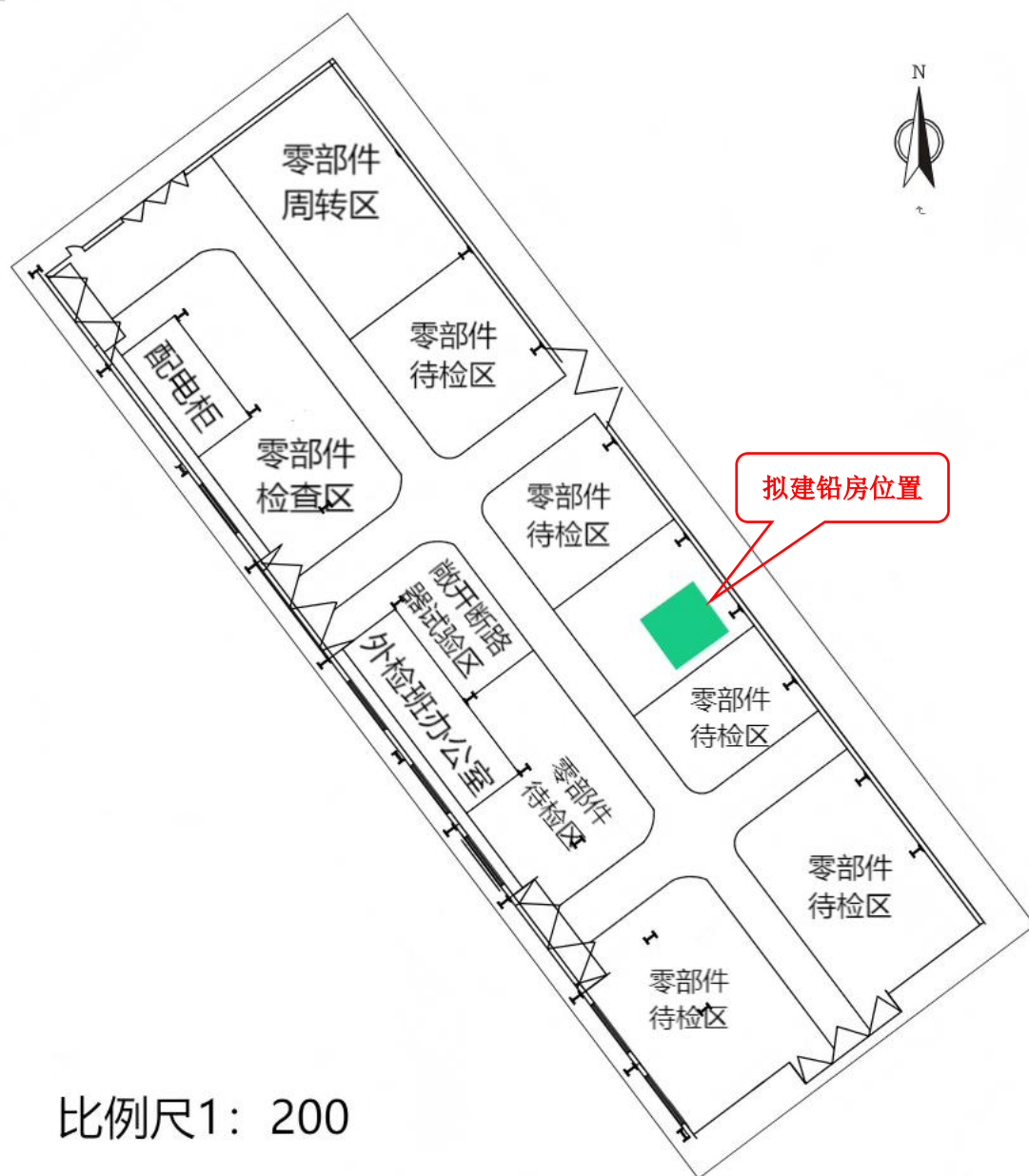
图 1-4 外检车间平面布置示意图
