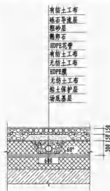
图 2.2-6 支盲沟断面示意图
