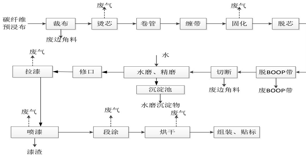
图 2-2 项目鱼竿生产工艺流程及产污环节图
