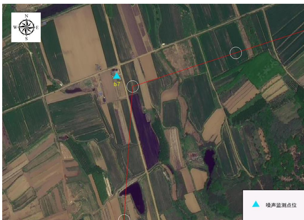
图 3-1c 储能电站至文登站 110kV 单回输电线路环境敏感目标噪声监测布点图
