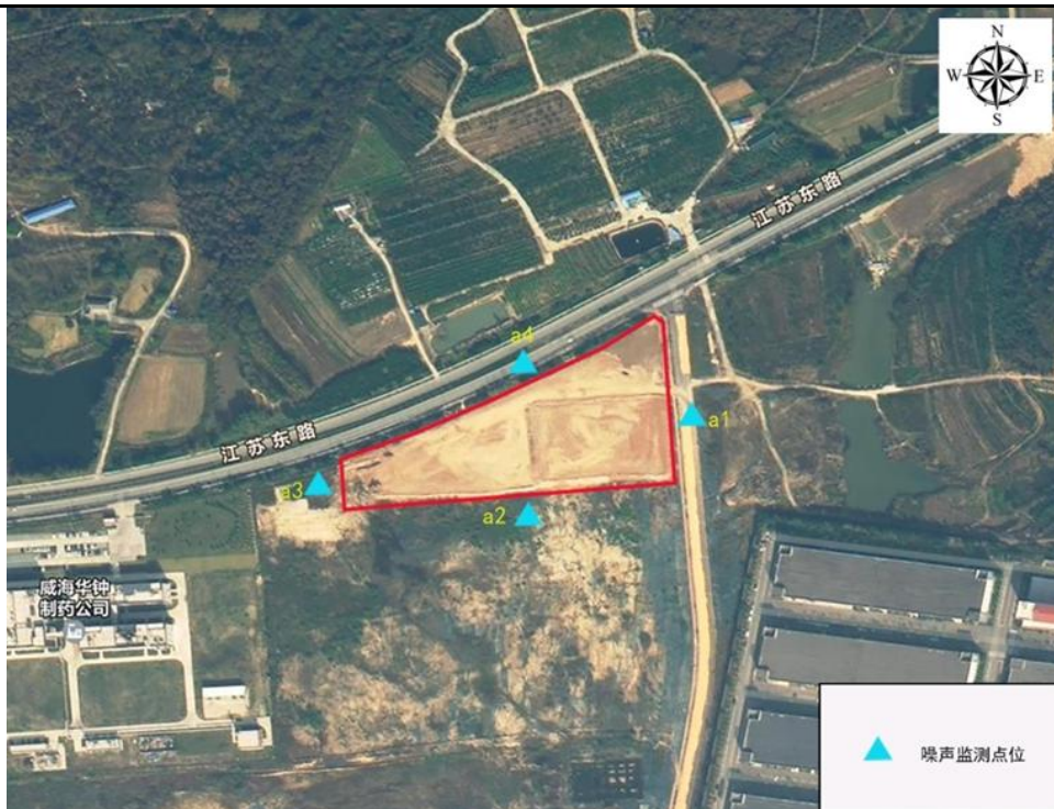
图 3-3 储能电站噪声监测布点图
