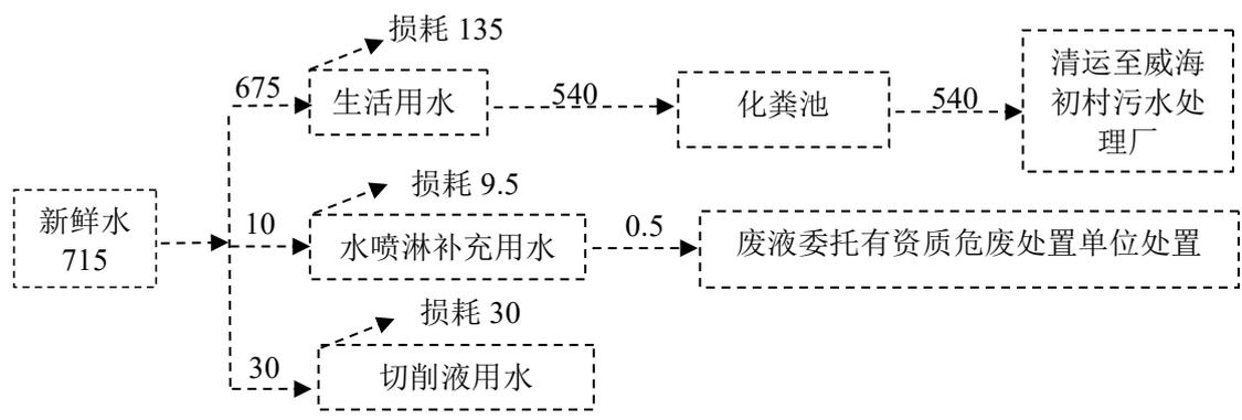
图 2-1 项目水量平衡图 (m<sup>3</sup>/a)
