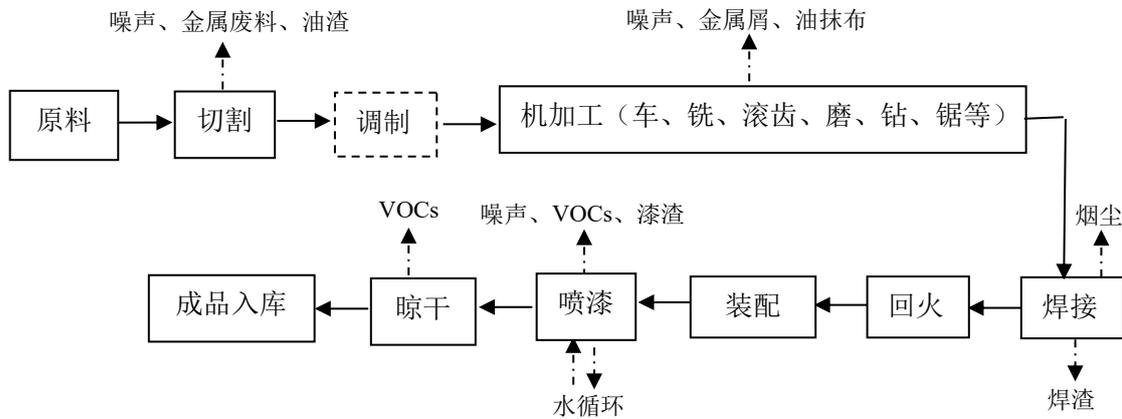
图 2-2 螺旋液压马达生产工艺流程及产污环节图
