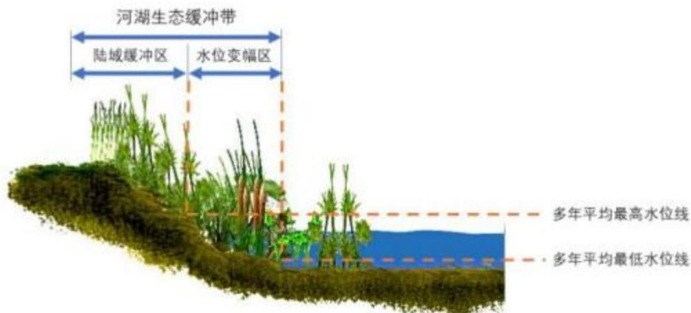
图3 典型河湖生态缓冲带结构示意图
