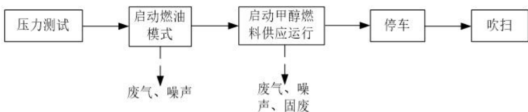
图2-9 甲醇燃料测试工艺流程
