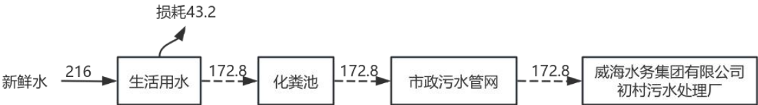
图 2-1 本项目水平衡图 (单位: m³/a)
