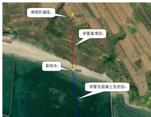
图 3.3.4-3 200kV 海缆登陆段示意图
