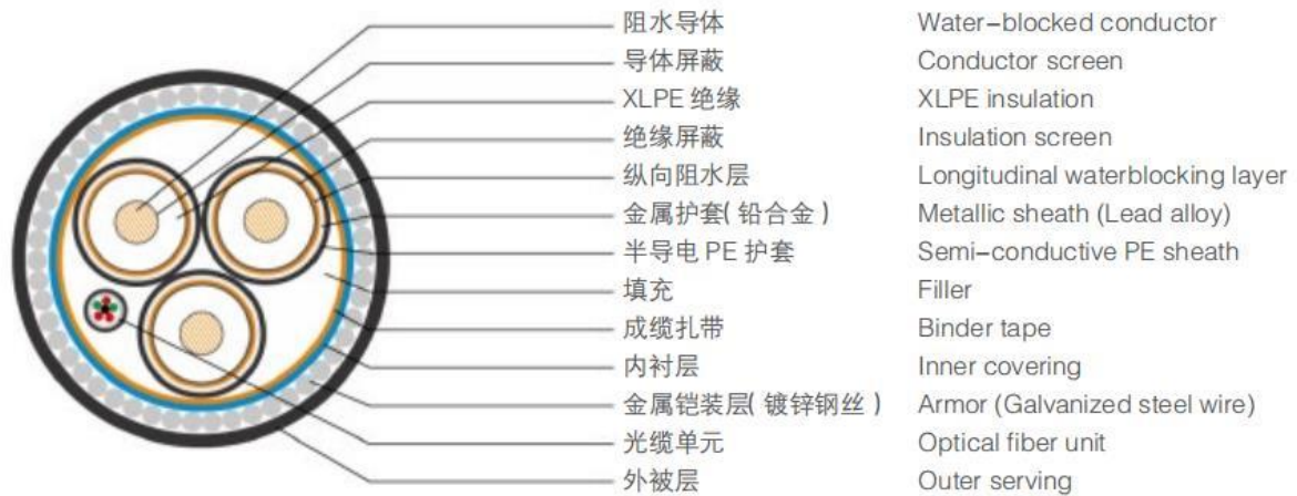
图3.2.3-3a 220kV三芯海底电缆结构断面示意图
