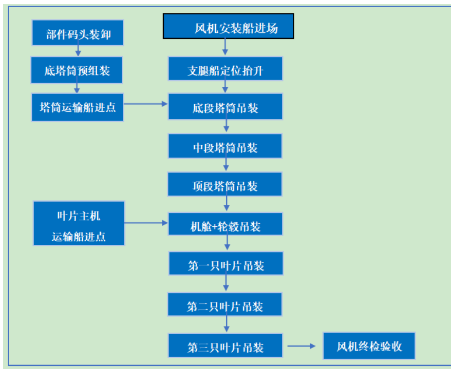
图3.3.3-1 风机分体式吊装施工流程图
