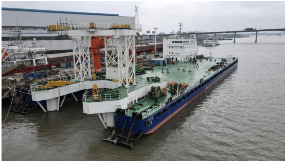
图 3.3.2-2 船载式稳桩平台
