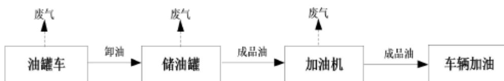
图 2-8 项目柴油运营工艺流程及产污环节图
