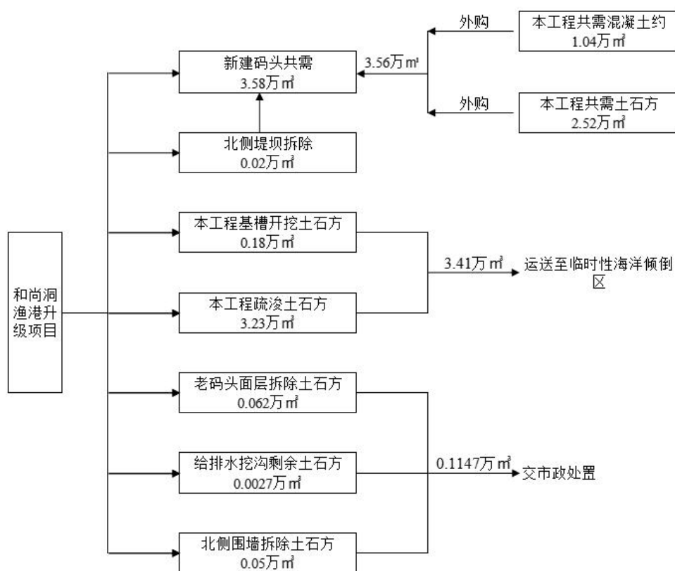
图 3.5-2 土石方平衡图
