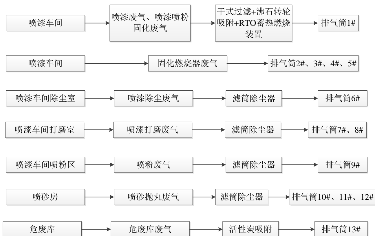
图 11.1-1 废气处理工艺流程图
