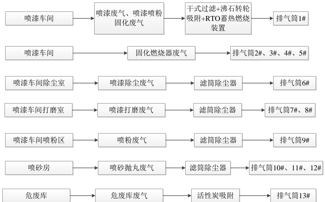
图 2.7-1 废气处理工艺流程图
