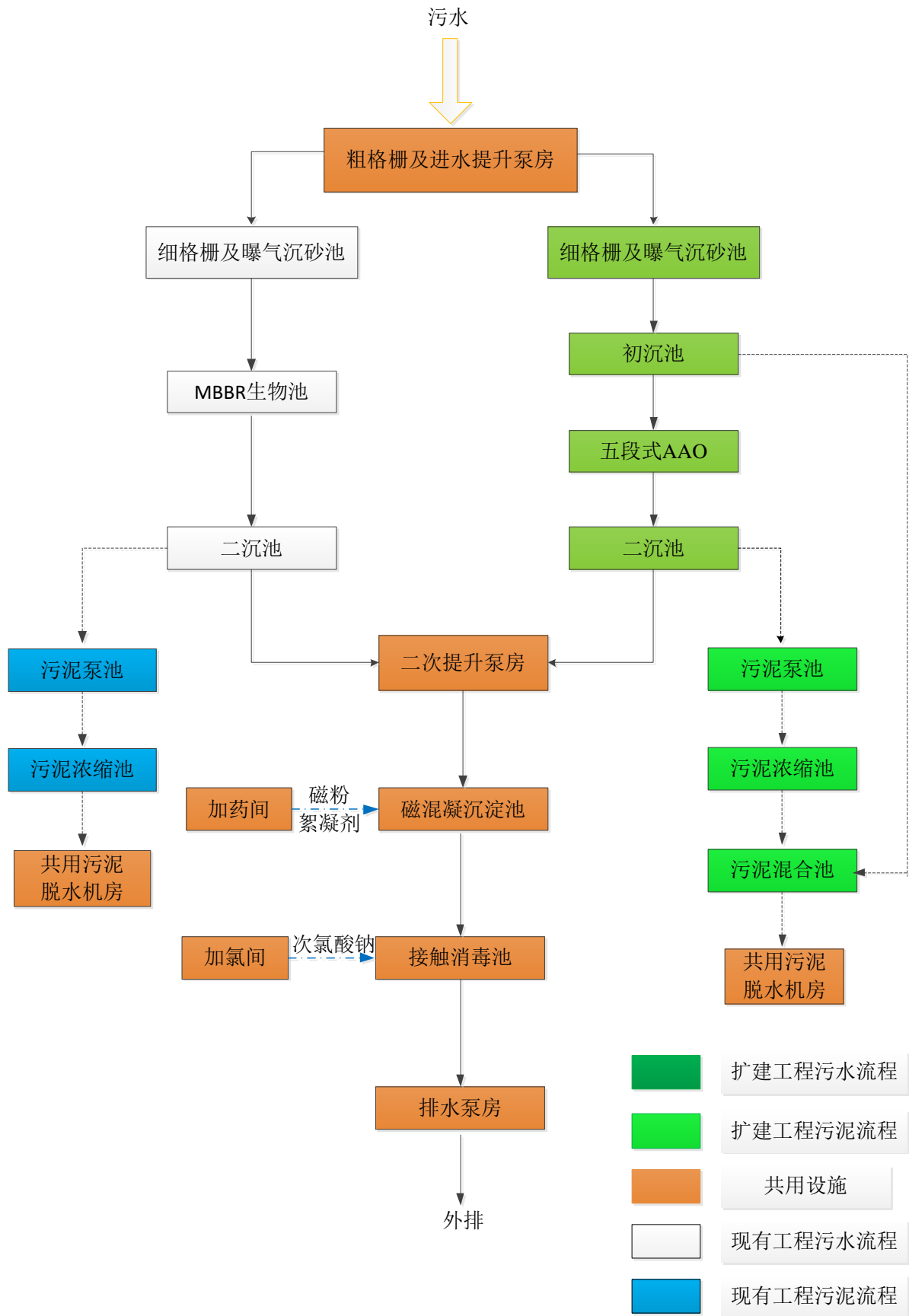
图 5.2-1 初村污水处理厂处理工艺流程图
