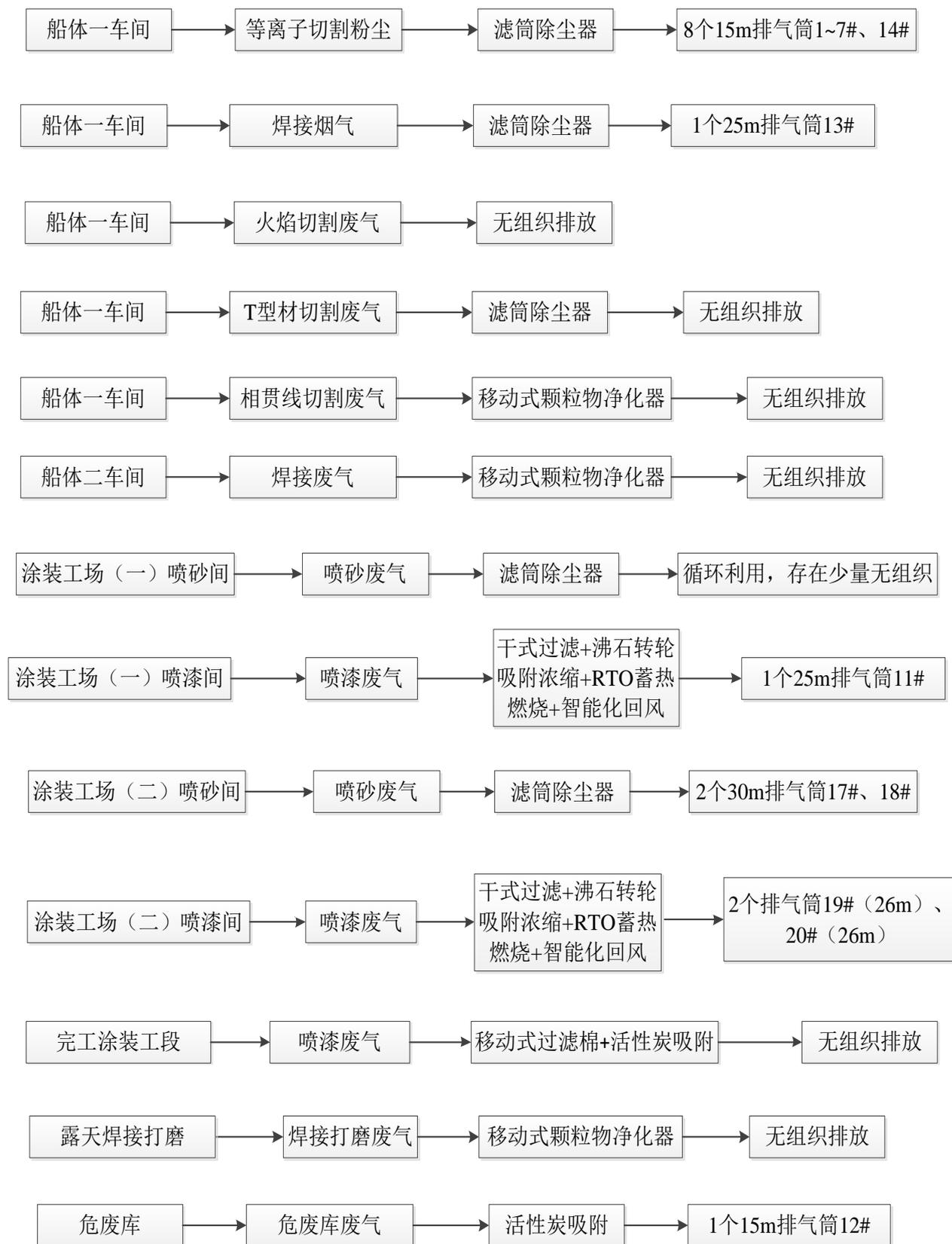
图 2.1-8 招商船厂废气处理工艺流程
