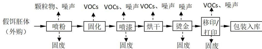
图 2-2 假饵生产工艺流程及产污环节图
