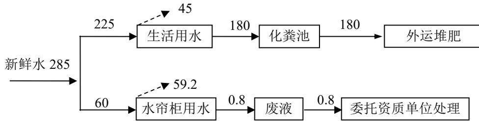
图 2-1 项目水量平衡图 (m³/a)
