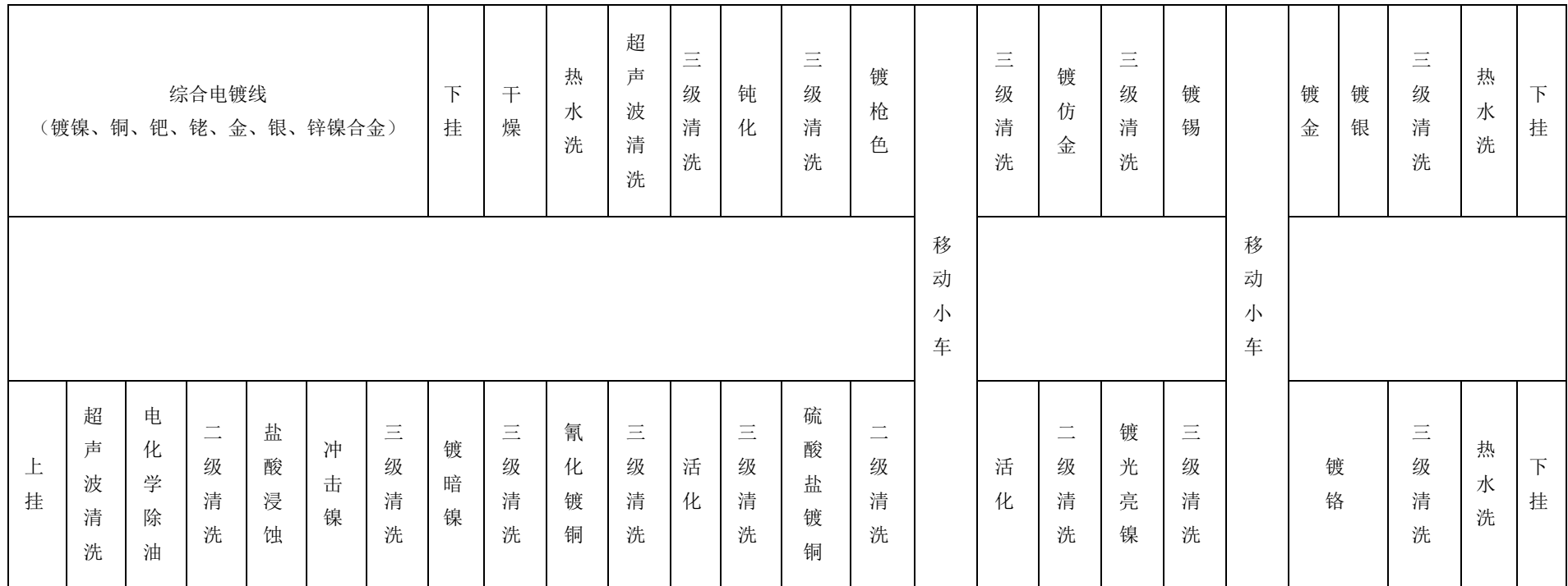
图 3.4-2 (1) 改扩建工程电镀生产线布置示意图
