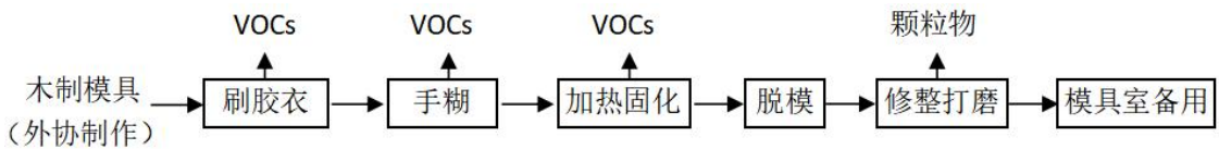
图 2-2 模具生产工艺流程及产污环节图
