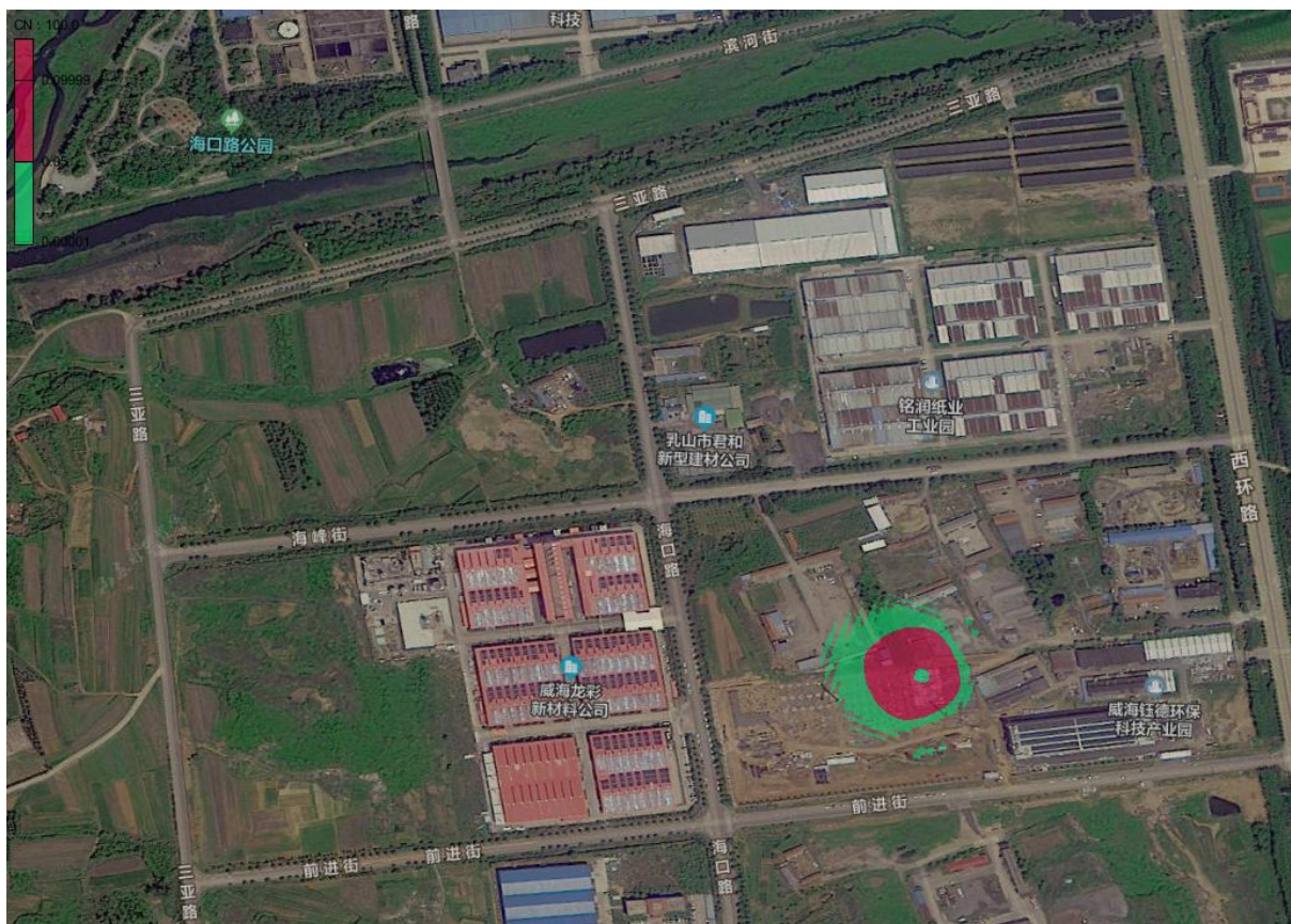
图 5.3-22 瞬时泄漏情况下总氰化物扩散 100d 示意图
