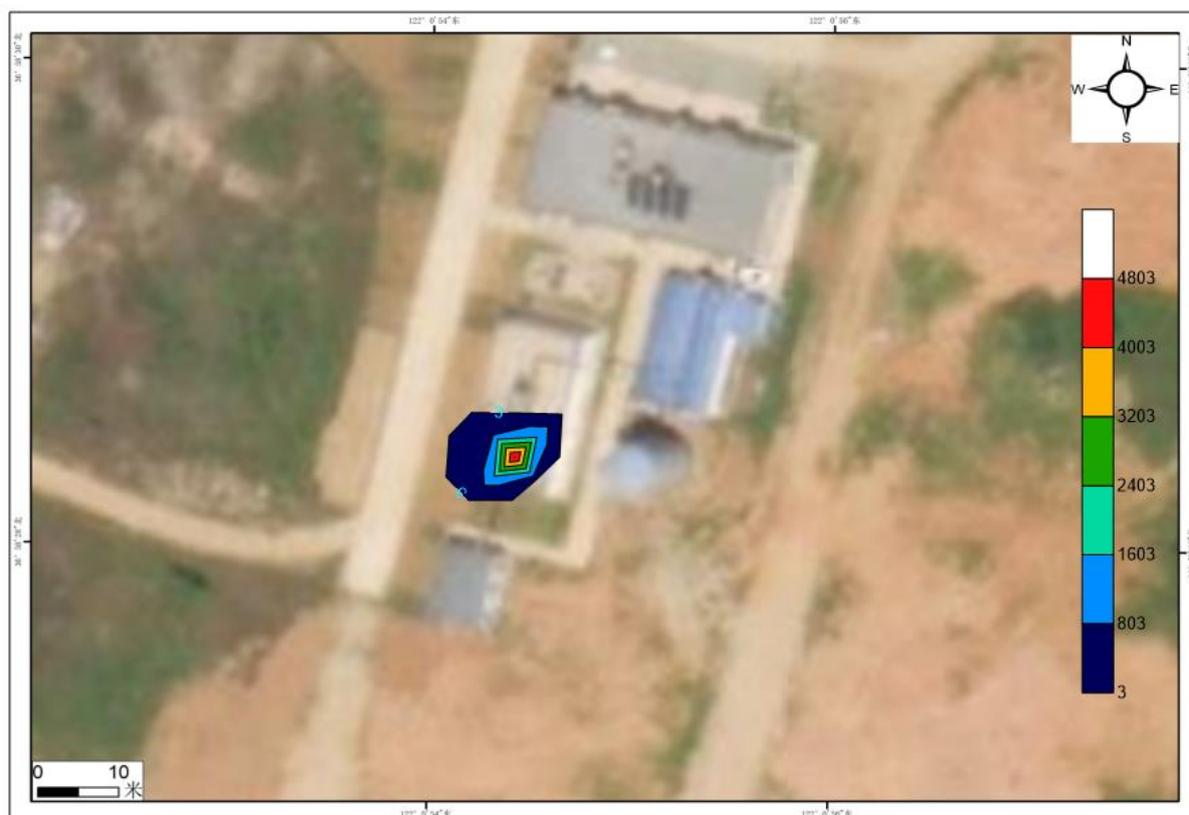
图 4.4-10 连续泄漏 COD<sub>Mn</sub>1000 天超标范围示意图
