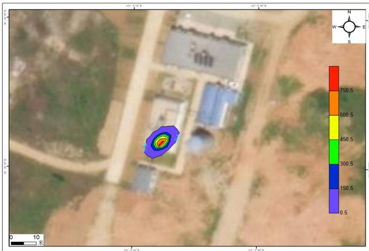
图 4.4-13 连续泄漏氨氮 1000 天超标范围示意图
