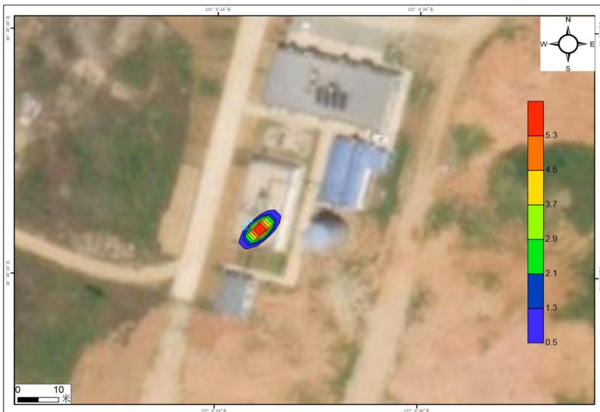
图 4.4-19 瞬时泄漏氨氮 1000 天超标范围示意图
