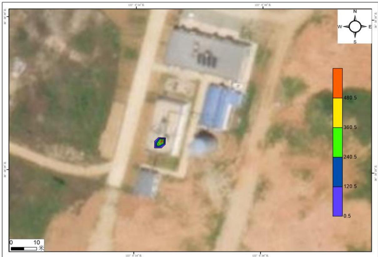
图 4.4-12 连续泄漏氨氮 100 天超标范围示意图
