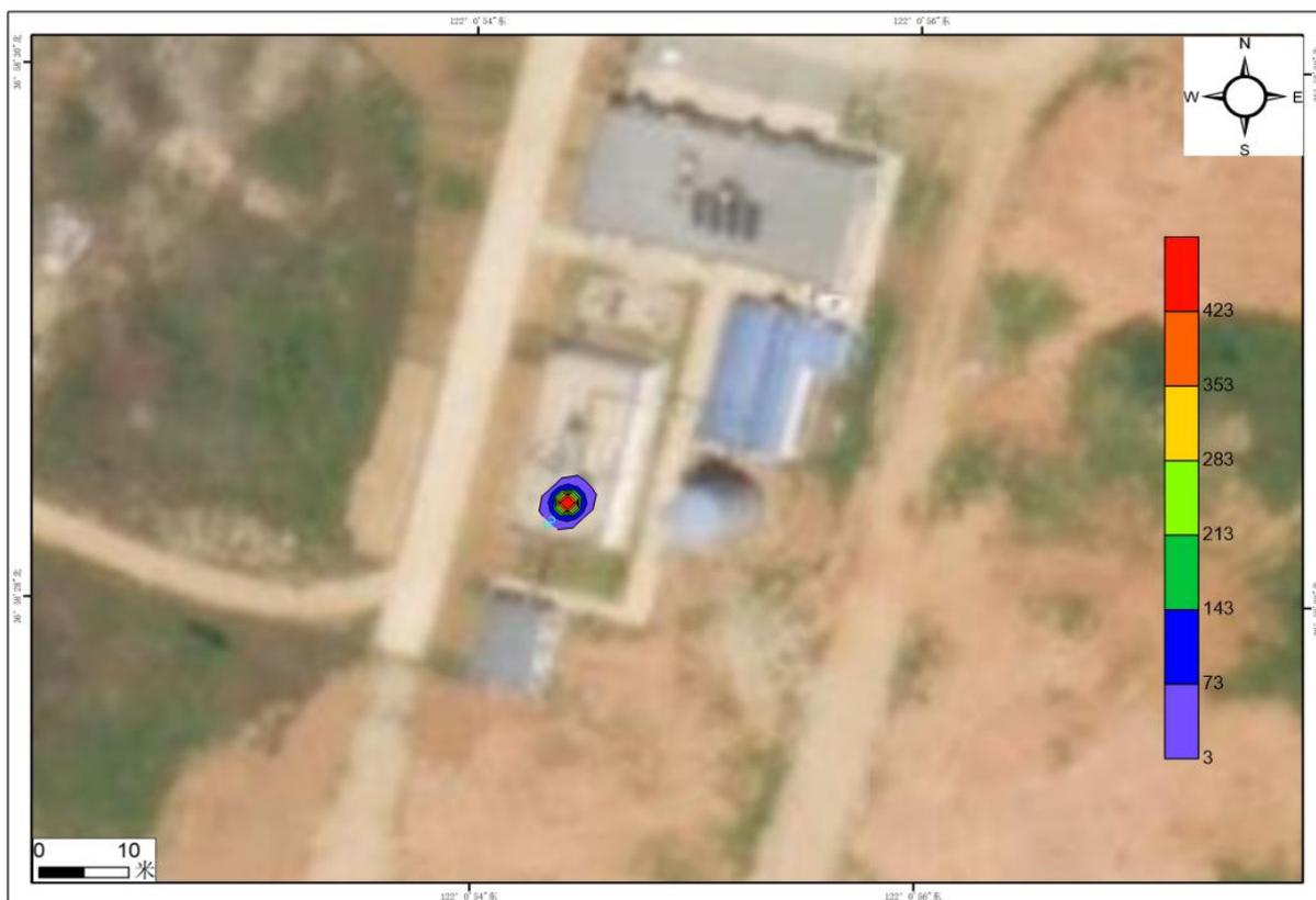
图 4.4-15 瞬时泄漏 COD<sub>Mn</sub>100 天超标范围示意图
