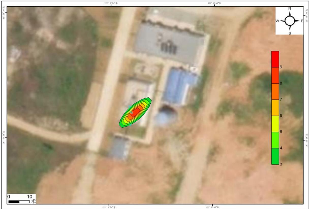
图 4.4-17 瞬时泄漏 COD<sub>Mn</sub>7300 天超标范围示意图
