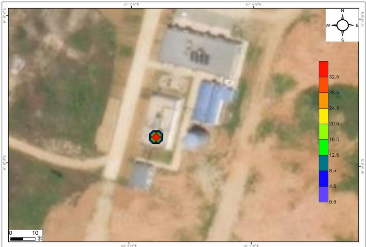
图 4.4-18 瞬时泄漏氨氮 100 天超标范围示意图
