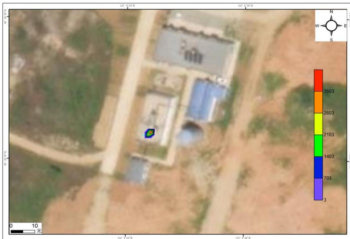
图 4.4-9 连续泄漏 COD<sub>Mn</sub>100 天超标范围示意图
