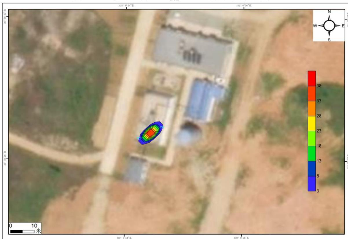
图 4.4-16 瞬时泄漏 COD<sub>Mn</sub>1000 天超标范围示意图
