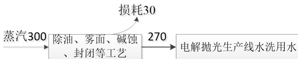
图 2.7-2 项目蒸汽平衡（单位： \text{m}^3/\text{a} ）
