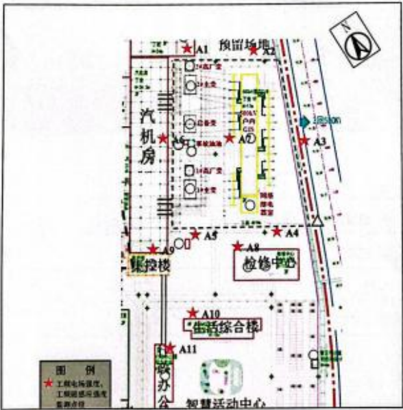
附图 1-2 电磁检测布点示意图
