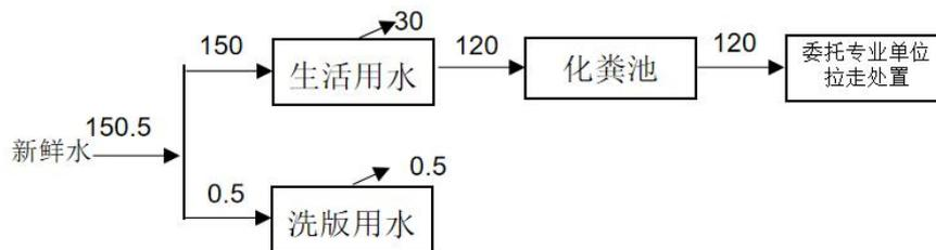
图 1 项目水平衡图 (m<sup>3</sup>/a)
